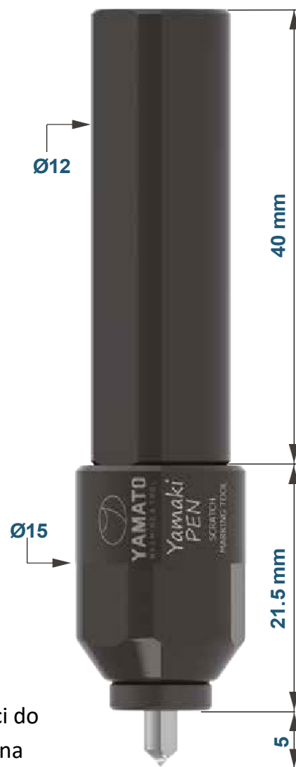
ŚRUBA DO REGULACJI GŁĘBOKOŚCI ZNAKOWANIA ZMIENIA NACISK SPRĘŻYNY
